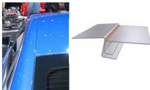
図2 自動車のドアとルーフのレーザーろう付 (EDA G社)
